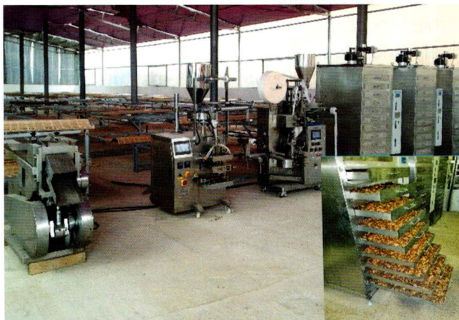
Hệ thống thiết bị sơ chế nguyên liệu, máy đóng gói và lò sấy hồng ngoại được liên tục vận hành tại Viện IMI chế tạo.
